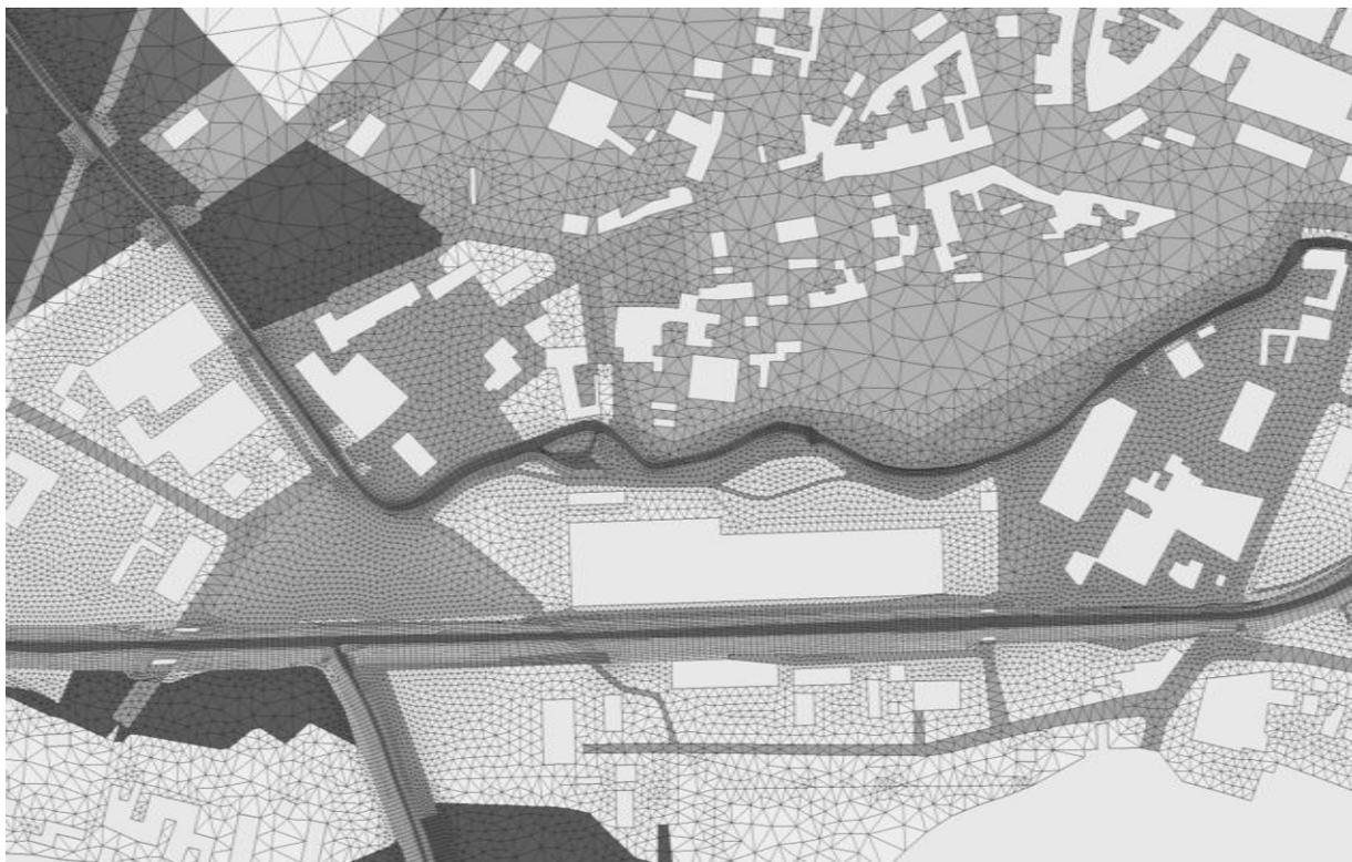
**Abbildung 6:** Finite-Elemente-Netz im Bereich Großenhain
