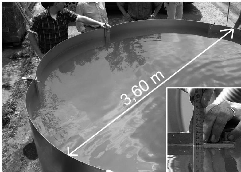
**Abbildung 2:** Tragwerk-Test eines Linienschutz-Systems mit  $h = 1,30$  m Schutzhöhe
