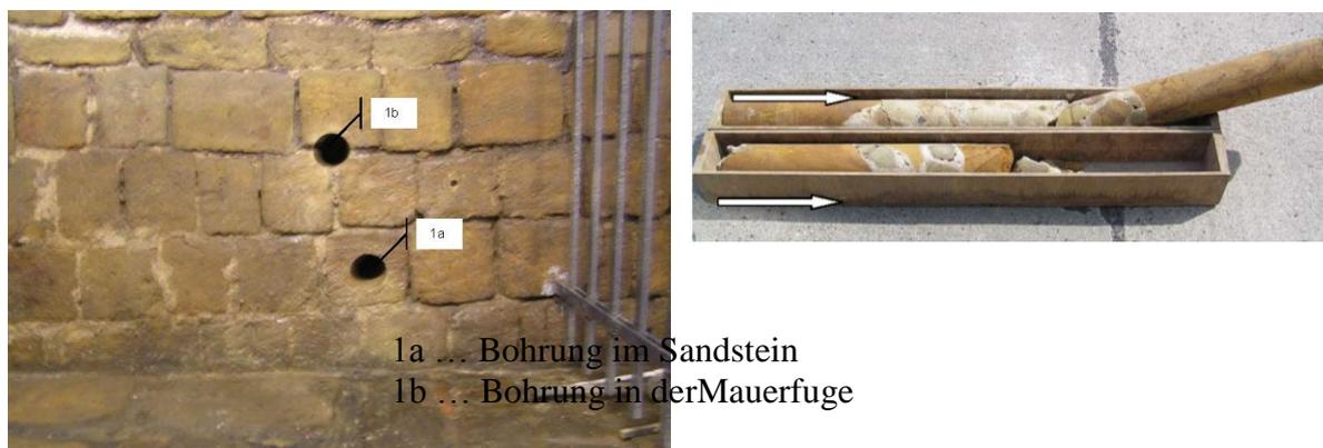
**Abbildung 4:** Bohrkerneentnahme in der Brühlschen Terrasse (Scholz + Lewis 2006 A)
